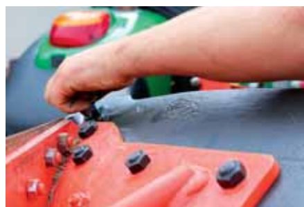
Śruba wysokiej klasy i jej nakrętka minimalizują ryzyko zgubienia lemesza po uderzeniu w kamień.
