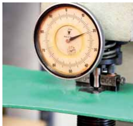
Wynik w HRC badania twardości lemesza ze stali szynowej.
